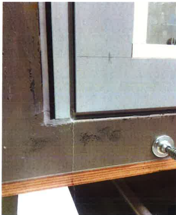
Infiltration sous 200 Pa
