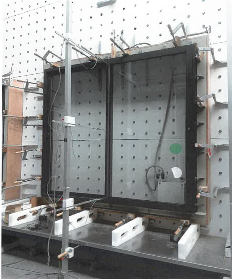
Elévation du châssis testé
